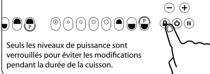
**Étape 4.** Toucher le verrou pour réinitialiser le réglage du niveau de puissance (a) ou la touche de puissance pour éteindre la plaque (b).
