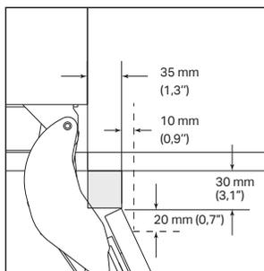
L'appareil permet d'inverser le côté des charnières et donc le côté d'ouverture des portes. Même dans le cas de portes inversées, les dégagements restent les mêmes que ceux indiqués précédemment.
