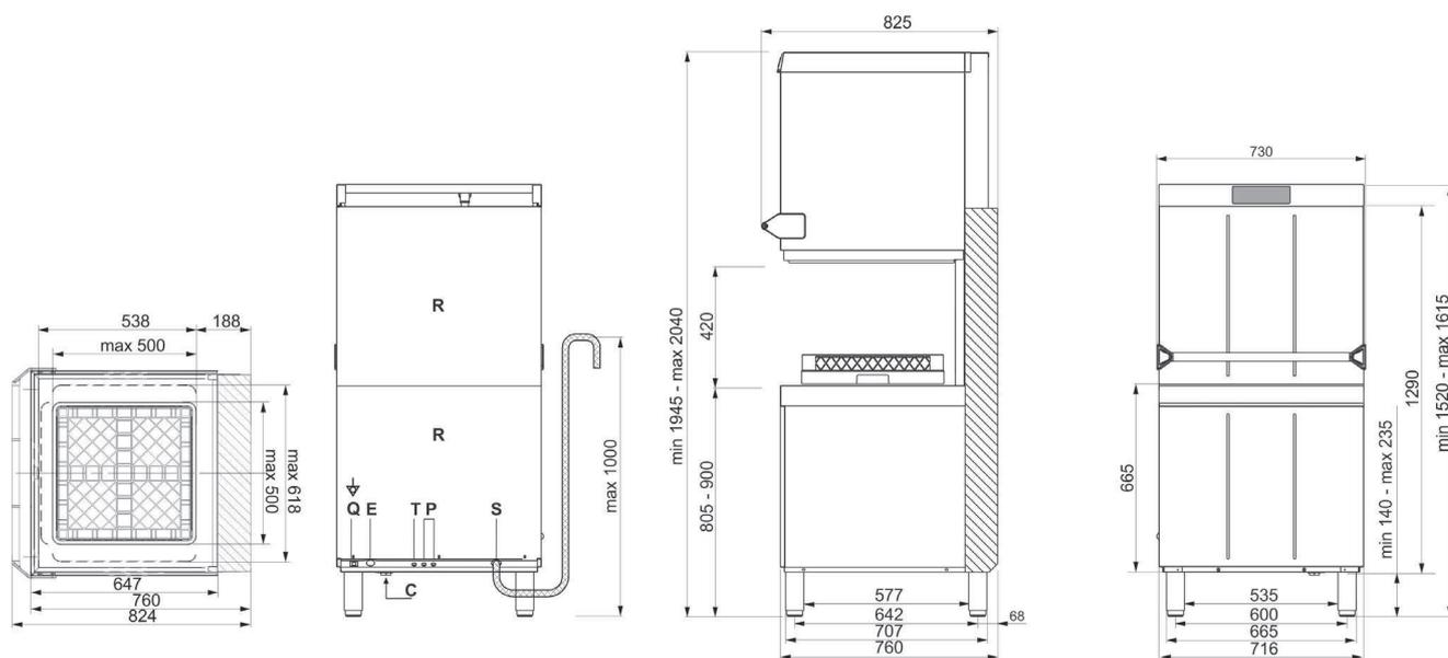
Dans le modèle avec système de condensation vapeurs SHR (HTY620DH), la profondeur augmente de 80mm
