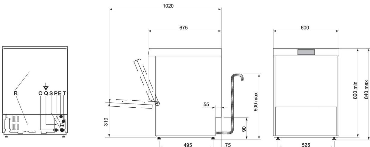
Dans les modèles de lave-vaisselle frontaux pour plaques, la profondeur augmente de 80mm
